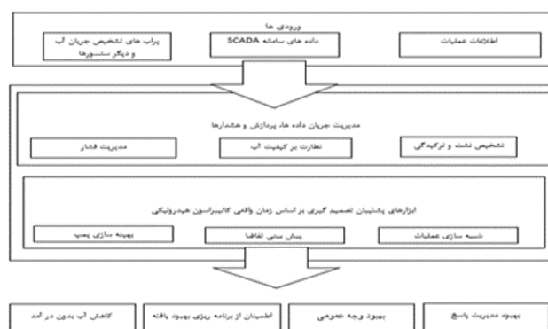
شکل ۱: بررسی اجمالی عملکرد پلت فرم WaterWiSe با کاربردهای فعال شده توسط سیستم یکپارچه داده ۱ و هشدارهای الکترونیکی و ماژول پشتیبانی از تصمیم ۲ و یک مجموعه منتخب از مزایای دیده شده (مایکل الن و همکاران، ۲۰۱۲).
