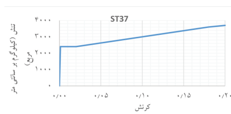
شکل ۷. منحنی رفتاری فولاد مورد استفاده
