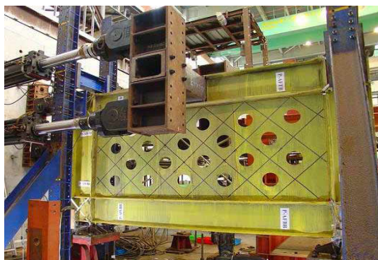
شکل ۳. نمایش نحوه بارگذاری و آرایش بازوها در نمونه وین و برونو
